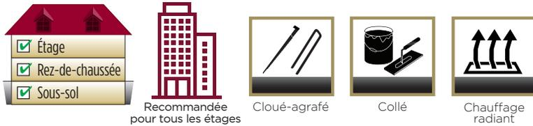
Les planchers contrecollés Mirage peuvent être installés à l'étage, au rez-de-chaussée ou au sous-sol. Il est aussi possible d'installer la plupart des essences de bois par-dessus un sous-plancher muni d'un système de chauffage radiant à l'exclusion de l'Hickory.
