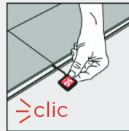
Lorsque la tige est insérée, bougez-la légèrement afin d'entendre le système de verrou se désengager.
